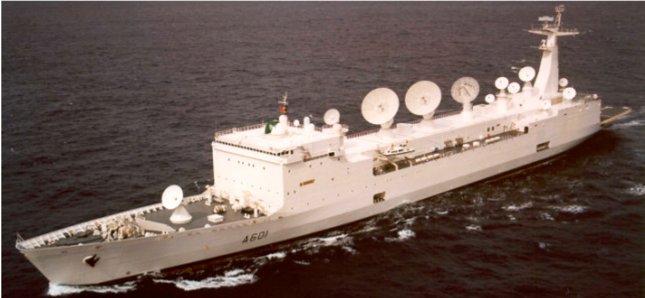
Fig. 7 Vue du Bâtiment d'Essais et de mesure MONGE et de ses deux radars ARMOR
